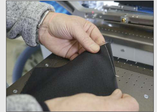
Exaktes Ausnähen in die Abnäherspitze (keine Tütenbildung)
