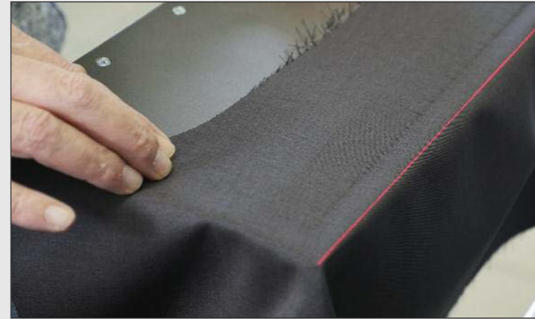
Anlegen des Nähteils an die Markierungsleuchten der Vorlegestation. Fixieren mit Vakuum.
