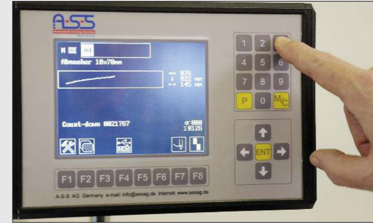
Übernahme und Nähen des programmierten Abnähers mit X-Y-Steuerung.
