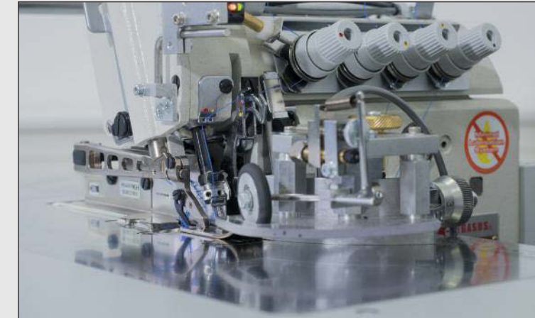
Die optimale Einheit für Umstecharbeiten: Konturenführung, Fotozelle und Nähkopf.
