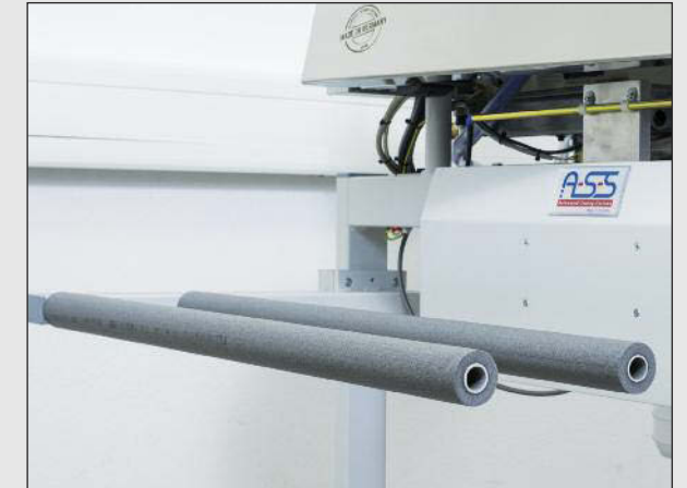
Die exakt und schnell arbeitende Staplereinheit legt die Nähteile zur weiteren Verarbeitung ab.
