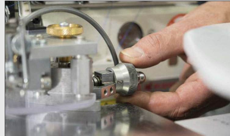
Mit der Schnellverstellung wird die Konturenführung an das Nähmaterial angepasst.
