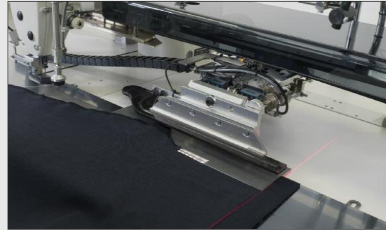
Das zuvor von der Bedienerperson genau positionierte Nähgut wird von der Transportklammer übernommen
