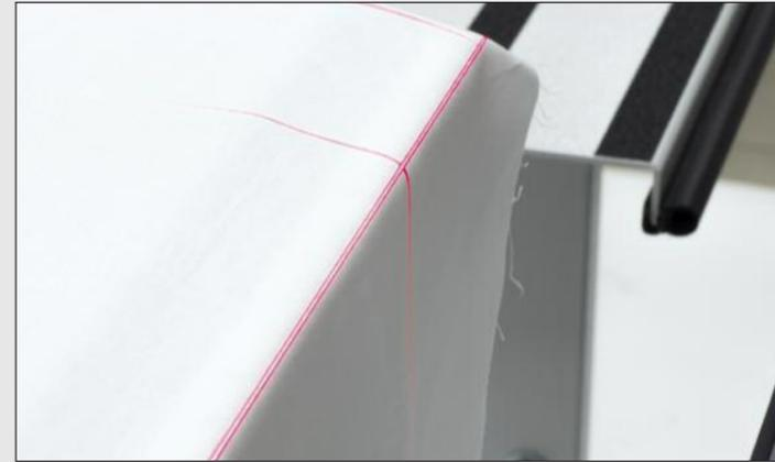
Anlegen des Nähteils an den Markierungsleuchten der Vorlegestation. Fixieren mit Vakuum.
