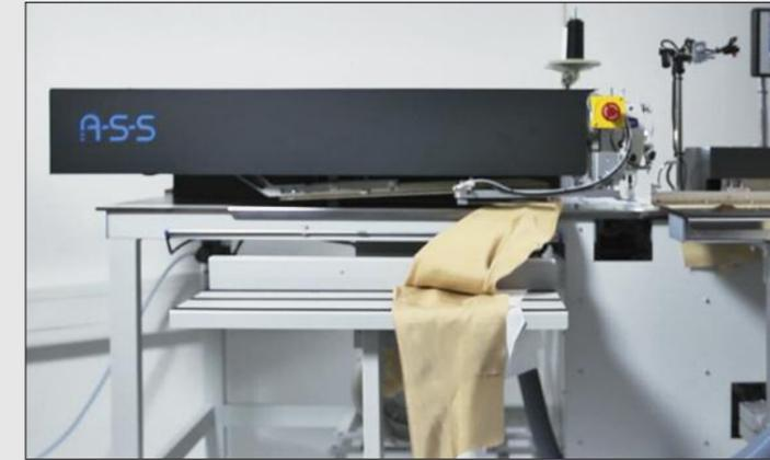
Automatisches Ab stapeln der genähten Teile
