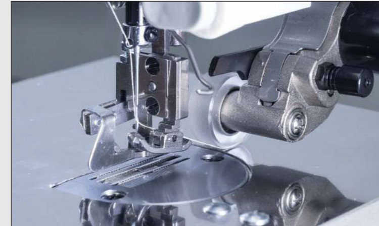
Spezieller Nähfuß für Stepparbeiten im Nahtschatten
