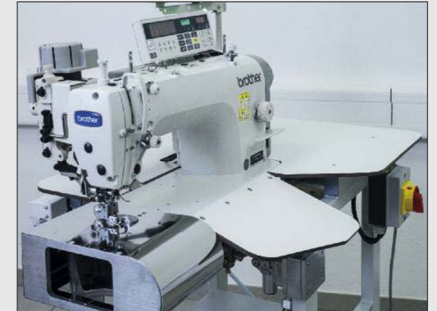
Produktionsgerecht ausgeformter Arbeitstisch
